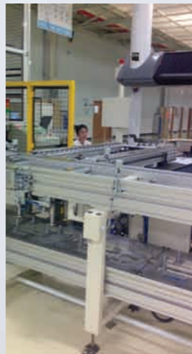
应用于动力总成生产线的自动上下料系统
